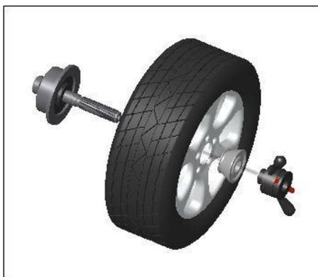
Hauptwelle - Rad - geeigneter Kegel (kleiner Kopf nach innen) - Schnellspannmutter
