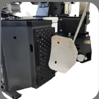
Leistungstarker seitlicher Abdrückzylinder mit 2500 kg Abdrückkraft und Schnellentlüftungsventil.
