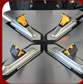
Automatisches 4-Klauen-System, großer Spannbereich, gefertigt aus Spezialstahl.
